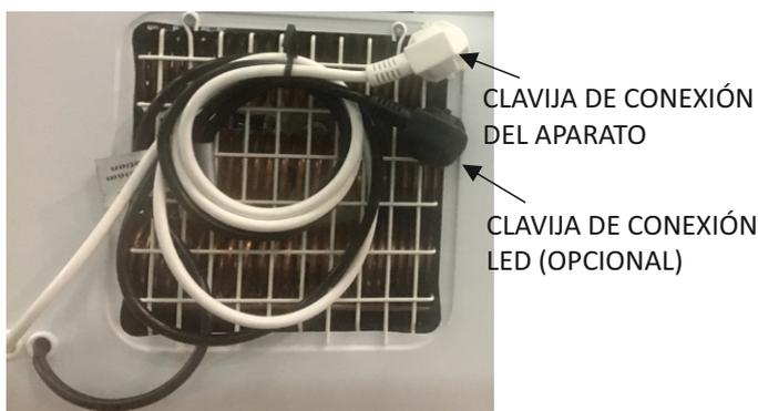
**⚠ ¡ATENCIÓN!** El cable de alimentación extra deberá estar conectado a un enchufe adicional e independiente del circuito de la toma del arca. Se debe ajustar la protección a la potencia del circuito de iluminación.
